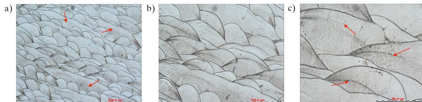
Rys. 4. Mikrostruktura próbki ze stopu Co-Cr-W-Mo o wysokości warstwy druku wynoszącej 30 \mu\text{m} – próbka niewyżarzana. Obrazy LM wykonano z powiększeniem: 100 razy (a), 200 razy (b) i 500 razy (c)
