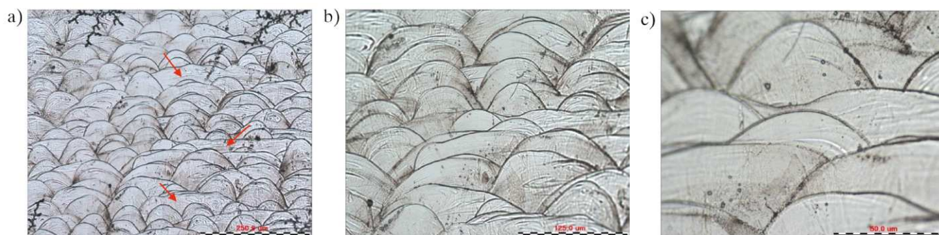
Rys. 2. Mikrostruktura próbki ze stopu Co-Cr-W-Mo o wysokości warstwy druku wynoszącej 20 \mu\text{m} – próbka niewyżarzana. Obrazy LM wykonano z powiększeniem: 100 razy (a), 200 razy (b) i 500 razy (c)
