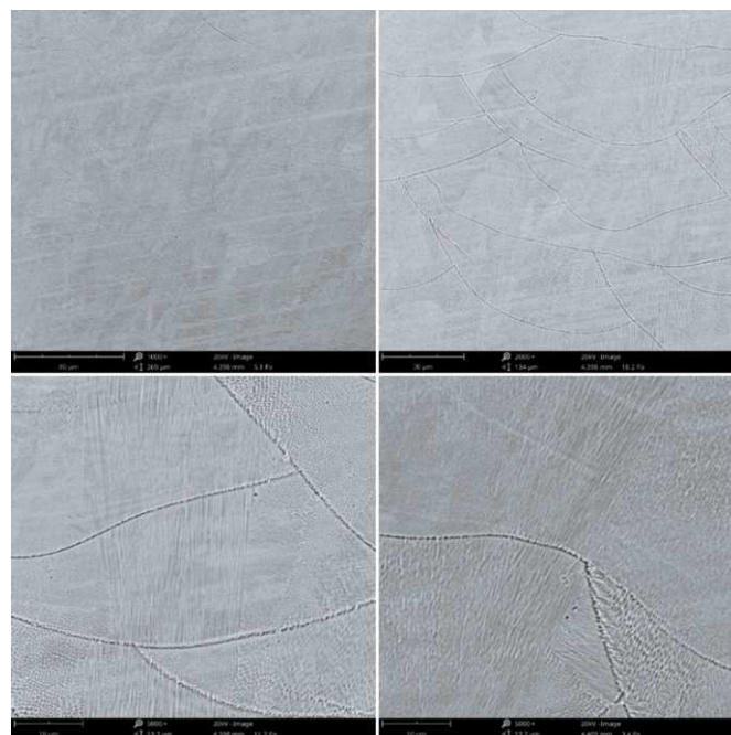
Rys. 10. Obrazy SEM próbki drukowanej ze stopu Co-Cr-W-Mo o wysokości warstwy druku 30 \mu\text{m} – próbka niewyżarzana. Zdjęcia wykonano z powiększeniem 1000 razy (a), 2000 razy (b) i 5000 razy (c)
