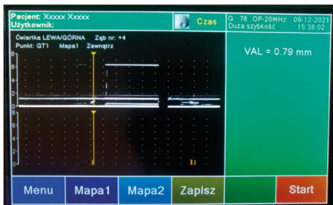
Rys. 7. Pomiar urządzeniem PIROP® w trybie M-mode z oznaczoną grubością tkanek w punkcie GT1 przy zębie 24
