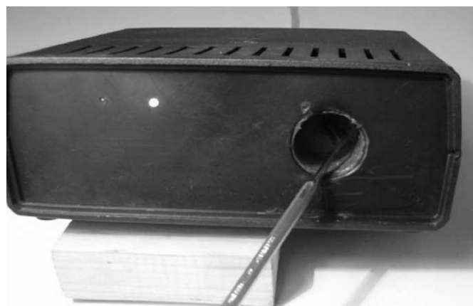
Rys. 5. Narzędzie ferromagnetyczne umieszczone w otworze prototypu urządzenia. Widoczne wyłożenie otworu materiałem silikonowym
