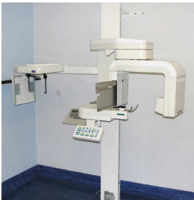
Rys. 7. Analogowy aparat pantomograficzny z przystawką cefalometryczną: ustawiony w trybie cefalometrycznym – wiązka pierwotna przechodzi w części przez klin aluminiowy umieszczony na brzegu wózka kasety. Źródło: zbiory własne
