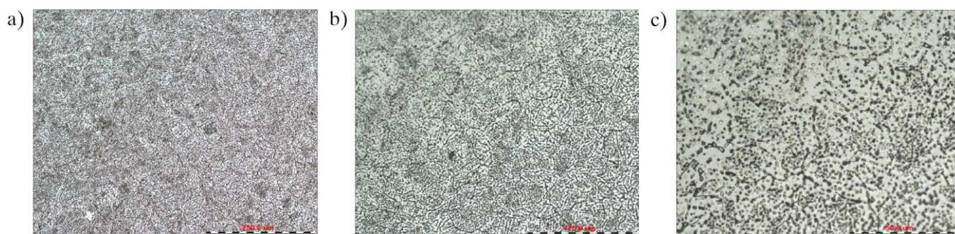
Rys. 3. Mikrostruktura próbki ze stopu Co-Cr-W-Mo o wysokości warstwy druku wynoszącej 20 \mu\text{m} – próbka wyżarzana. Obrazy LM wykonano z powiększeniem: 100 razy (a), 200 razy (b) i 500 razy (c)
